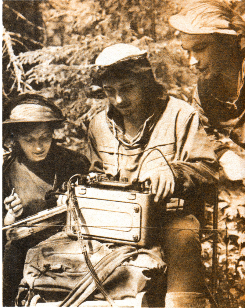
ГЕОФИЗИКИ ВЕДУТ НА ИШКОВСКОМ УЧАСТКЕ РАЗВЕДКУ МЕТОДОМ ВЕРТИКАЛЬНОГО ЭЛЕКТРОЗОНДИРОВАНИЯ.
